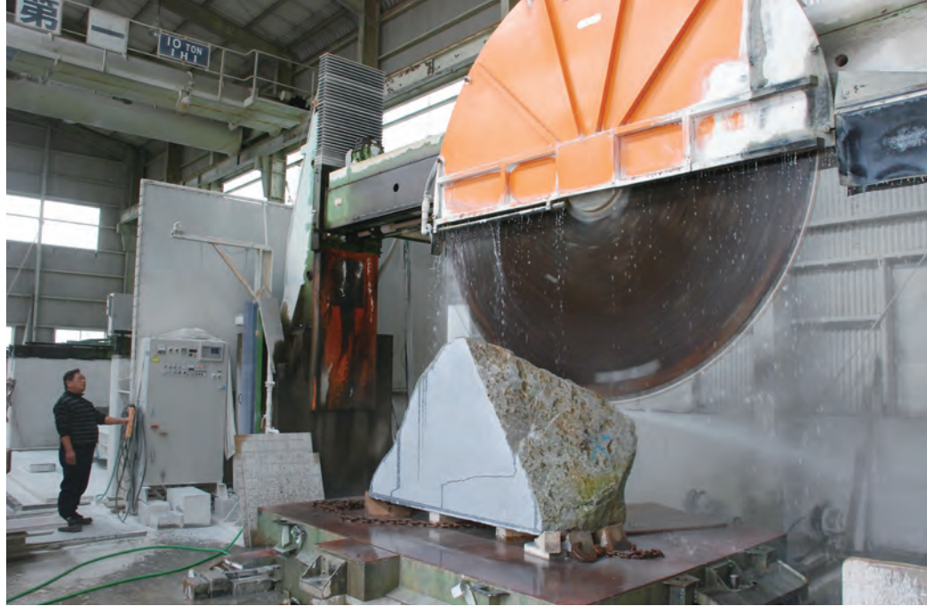
【右】大石産業(株)工場にて、庵治石を切削する大口径と、出荷間近の洋型墓石
