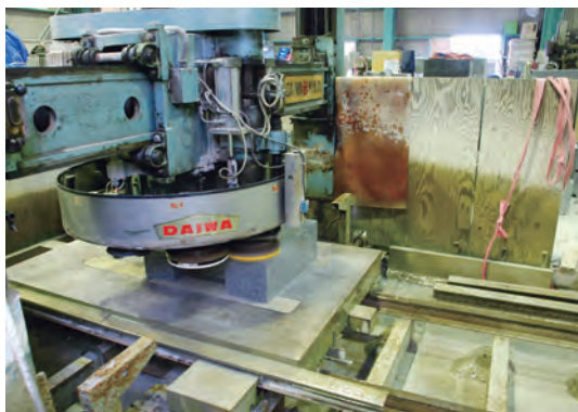
牟礼町内の墓石加工工場にて。庵治石を研磨する自動研磨機。同工場ではこだわりの研磨方法を採用し、建墓後長期間のツヤを維持する
